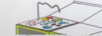
2 もう1本のアルミ芯を好きな形に曲げ、箱の「ピカピカ棒」の位置にさす。グラグラする場合は裏からセロハンテープで固定する。
