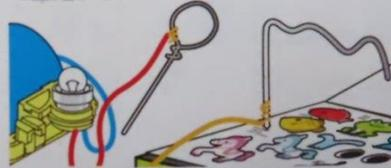
4 ①の輪をつかったアルミ芯に豆電球の赤い導線をつなぐ。箱にさしたアルミ芯に黄色のビニール導線をつなぎ、きつく巻き付ける。
