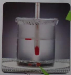
ほう温度計の液のため、ピーカーの底につかないようにする。
