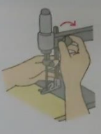
板おさえを、板のあつみに合わせて調節し固定したら、電気をいれる。
