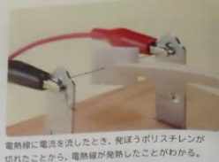
電熱線に電流を流したとき、発熱ポリスチレンが切れたことから、電熱線が発熱したことがわかる。
